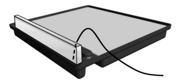
3.8 Вставьте поддон для воды в инкубатор и протяните трубку назад так, чтобы она аккуратно лежала между блоком испарения и направляющей трубки для воды без перегибов. Закройте дверцу (см. раздел 5).
